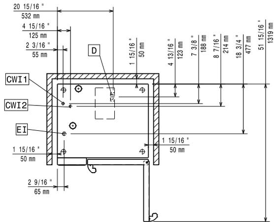
**Elektrik:****Devre kesici gerekli****Voltaj:** 380-415 V/3N ph/50-60 Hz**Elektrik gücü max:** 11.8 kW**Elektrik gücü:** 11.1 kW**Su:****Electrolux Professional** belirli su koşullarının testine dayalı olarak artırılmış su kullanılmasını önerir.
